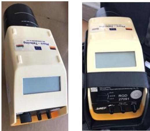
Figure 2: X-Ray-Gamma-Dosimeter RGD 27091.
